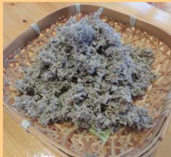
▲新聞紙をリサイクルして作られた断熱材(壁の中に注入するタイプです。)ダニやカビ繁殖の原因となる湿気も吸い取ってくれます。
