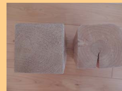
▲左が対馬ひのき。年輪の詰まり具合によって、重さも違います。
